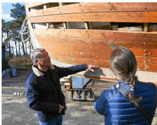
Daniel Lourau, président de l'association des Amis du Marche Avec, et Annick Martin, adjointe aux affaires maritimes. Tous les bordés du navire, en acajou, seront remplacés par de nouvelles pièces, en chêne.
