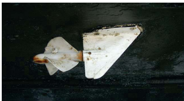
Un loch à hélice actuel fixé sur la coque, le comptage des tours est électronique / Rémi Kaupp
